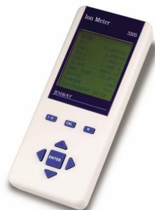
3205 手提式离子计用于快速, 简易并可靠地检测铵根离子、钙离子、氯化物、氟化物、和硝酸根离子浓度, 并以 mg/l, ppm, %, mol, 活性或者无单位形式显示。当用它进行离子分析是, 会自动选择恰当的 ATC 参数, 并且当将它和非常稳定的电极连接时, 在去田间分析前, 能在实验室读取所有的校准数据。尽管 3205 是为客户分析离子浓度而制造, 但它同时也可以用于 pH 值, mV 和其他非离子浓度的检测。
