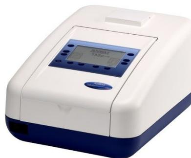
73 系列包括四种规格的新型分光光度计，加入 Jenway 产品的范围。这些分光光度计使用图象形式的编程软件，并具有一个改进的驱动系统，使客户能够简单而直观地使用。包括两个基础型号：7300 和 7305，以及其他两个改进的型号：7310 和 7315。7300 和 7305 以吸光度，透光率和浓度形式进行测量。
